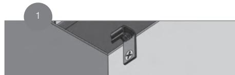
Nachdem Sie die letzte Terrassendiele positioniert haben, sichern Sie die Diele, indem Sie eine Schraube in einem Winkel von 30°-45° durch den Clip führen und festschrauben. Achten Sie darauf, dass die Schraube komplett eingedreht ist und die Diele nach unten zieht. Installieren Sie Endclips in einem Höchstabstand von 30 cm.
